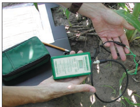
Figura 4. Utilizando el medidor portátil del sensor Watermark®.
