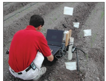
Figura 9. Bajando los datos del registrador de datos a una computadora personal.
